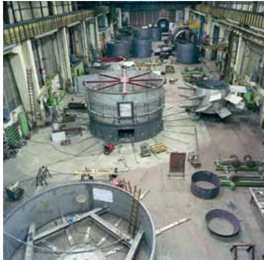
Instalaciones de difusión de BMA en fase de producción
