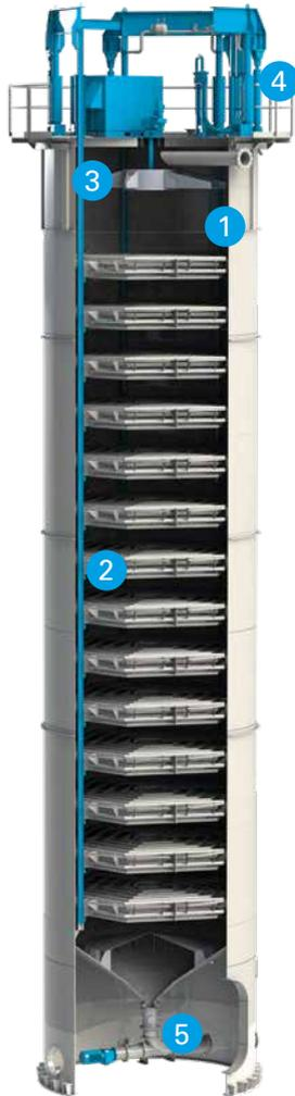
Les malaxeurs-refroidisseurs sont employés avec succès dans le monde entier pour assurer une cristallisation à la fois économique et optimale du sucre dans les suspensions cristallines (massecuite) de faible pureté, aussi bien dans les sucreries de betteraves et de canne que dans les raffineries de sucre.
