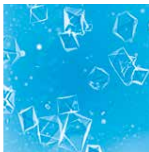
Cambio de las propiedades morfológicas de un cristal durante la fase de crecimiento de cristales en el ejemplo de un monosacárido.
