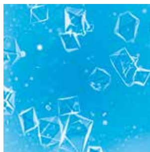
Veränderung der morphologischen Eigenschaften eines Kristalls im Verlauf der Kristallwachstumsphase am Beispiel eines Monosaccharids.
