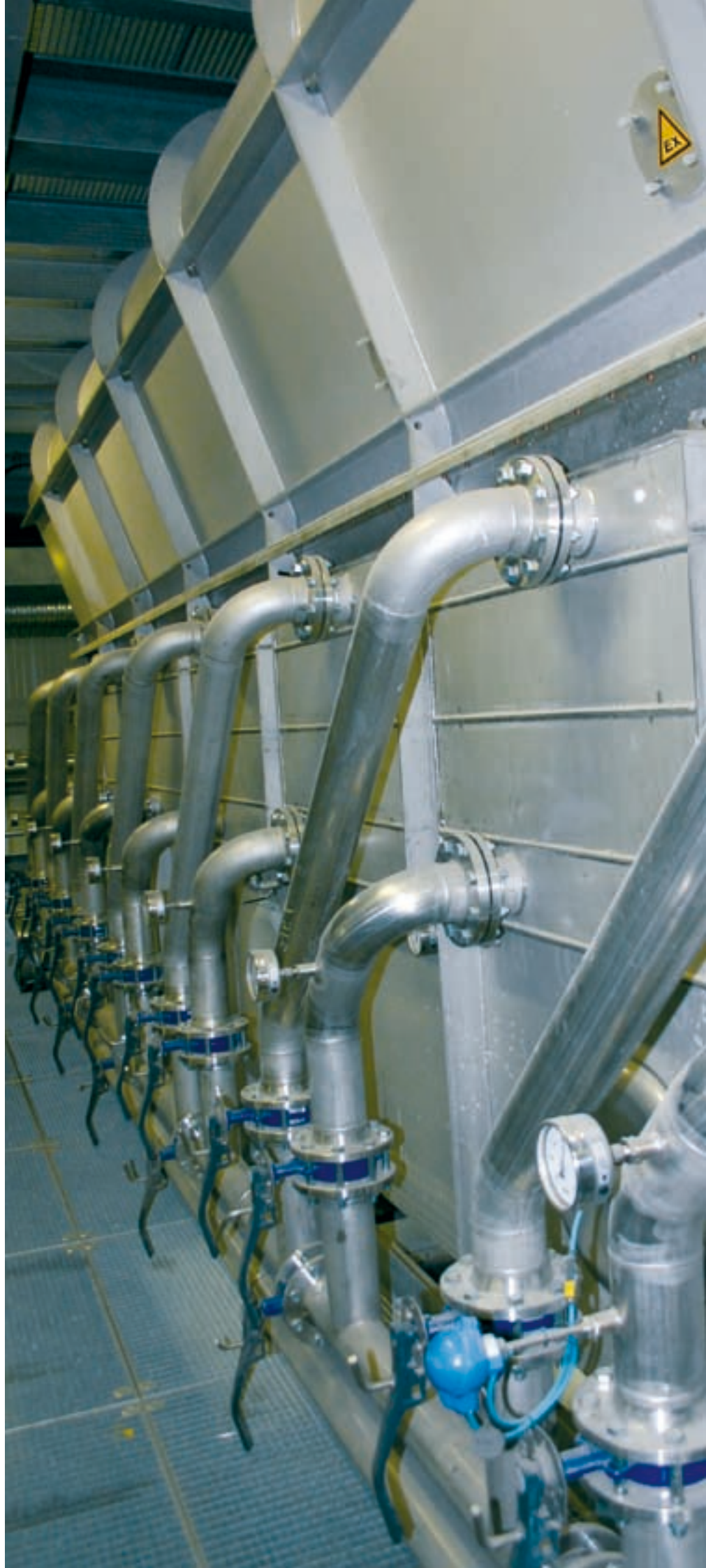
Охладитель с псевдо- ожигенным слоем на сахарозаводе Ste.Emilie, Франция
