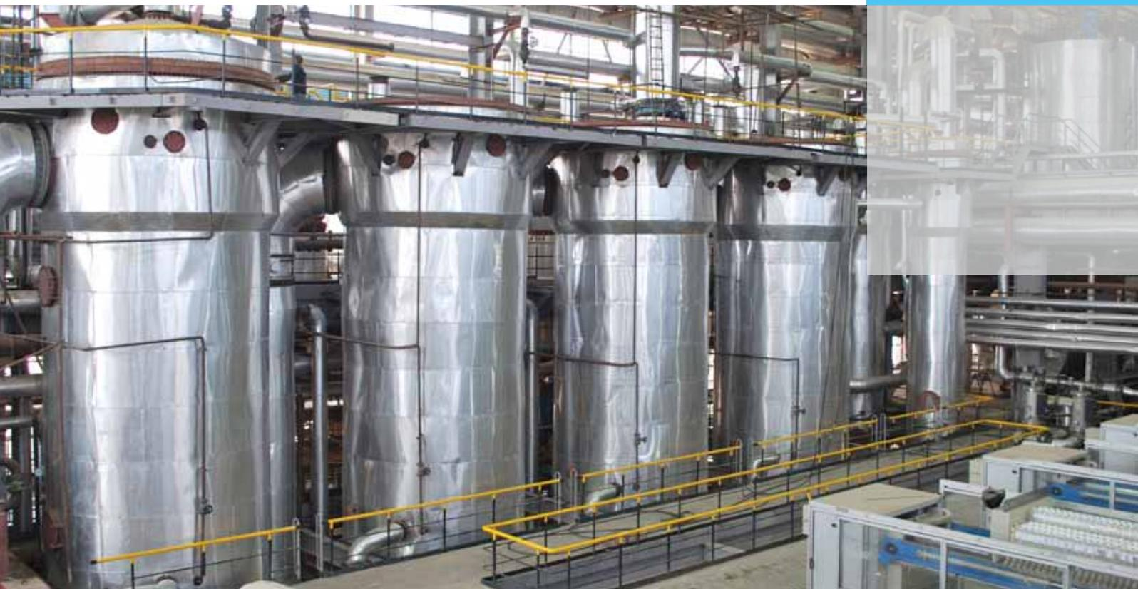
BMA ofrece una configuración individual del evaporador de película descendente conforme a cada aplicación. Por supuesto, la superficie de calefacción, la longitud de los tubos y el material empleado se adaptan al caso de aplicación concreto. Además, BMA ha elaborado soluciones especiales para diferentes condiciones de servicio del evaporador de película descendente:
