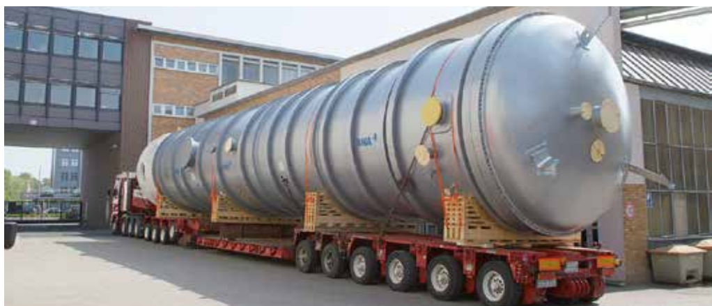
Плёночный выпарной аппарат отправляется в путь
