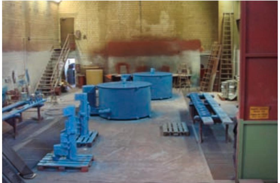
In einer Freistrahlkabine (4.600 x 5.000 x 12.000 mm) kann ein Reinheitsgrad nach DIN 55928, Sa 1, Sa 2, Sa 2,5 erzielt werden; Strahlmittel GH-K, Kornklasse 60-100.
