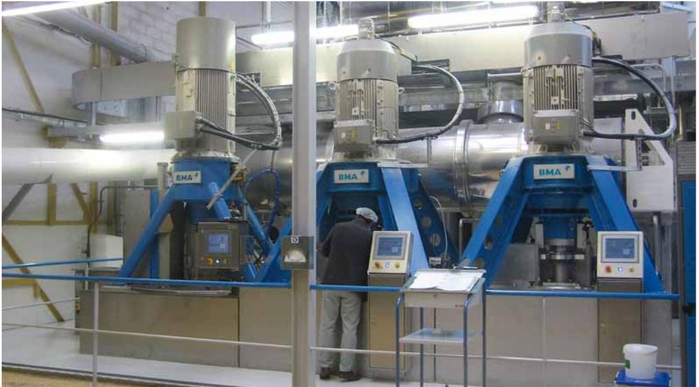
En 2009, con el modelo K3300 BMA ya lanzó al mercado una nueva centrifuga continua. También en este caso, el desarrollo se focalizó en la eficiencia, la estabilidad de proceso y en la simplicidad de conexión, operación y mantenimiento, así como en una alta disponibilidad de las máquinas. Poco después de su introducción al mercado, la K3300 ya ha logrado imponerse a nivel mundial. Por supuesto, BMA sigue su política de desarrollo continuo.
