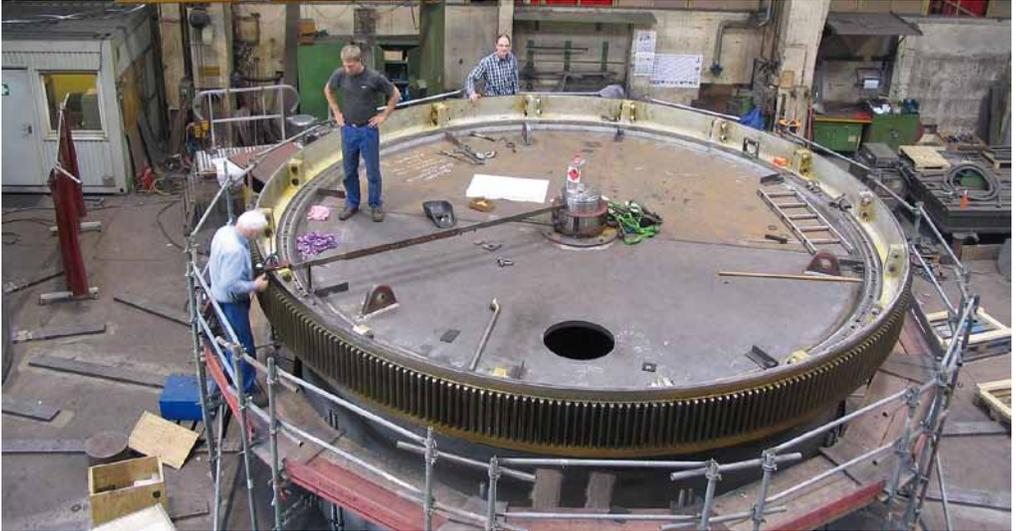
*Fabricación de la parte superior del árbol de la torre de difusión con corona dentada segmentada*
