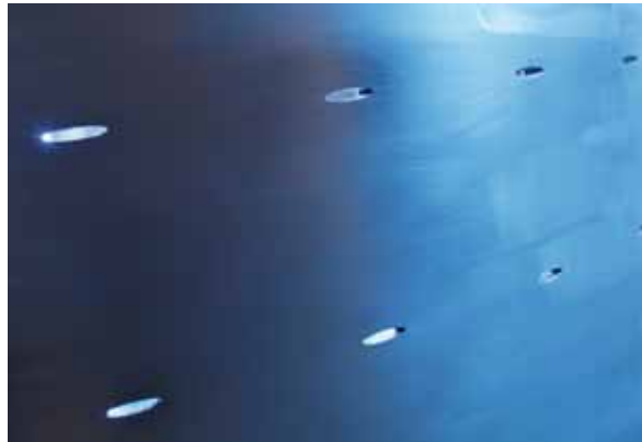
Новая рубашка ротора с эллиптическими отверстиями
