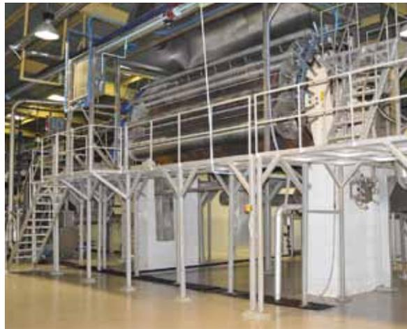
*Secador de cilindro para 500 kg/h de copos de patata*
