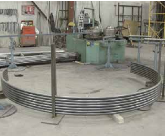
Taller de Brewer Steel con herramienta curvadora
