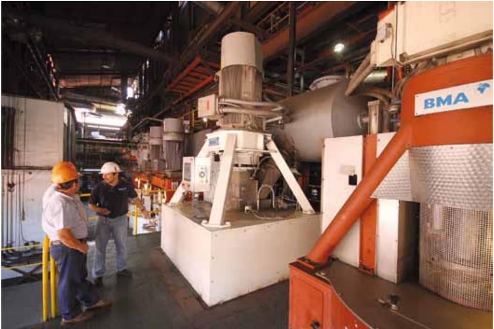
*Nueva centrífuga de alto rendimiento del tipo B1750 en La Unión (a la derecha: el modelo anterior G1750)*
