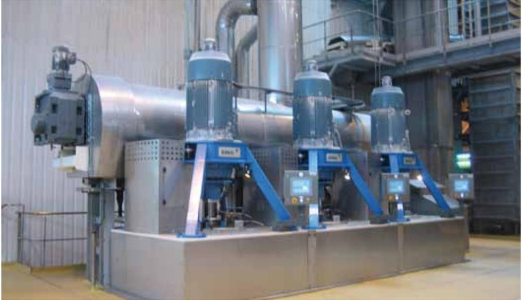
*Estación de centrífugas para masa cocida de primera:*
