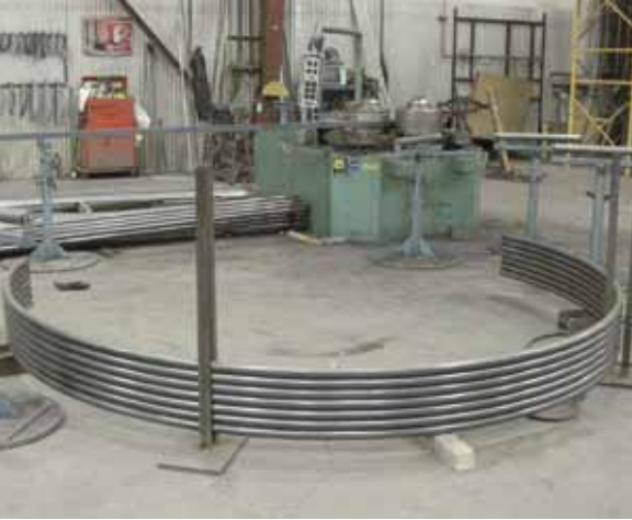
Werkstatt Brewer Steel mit Ringbiegewerkzeug
