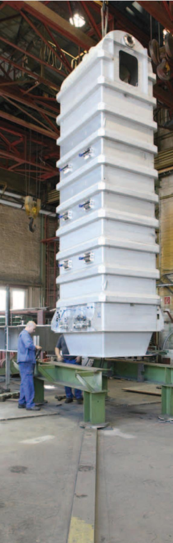
Ya con ocasión de la reconstrucción de la refinería de Port Wentworth, Savannah (Georgia, EE.UU.), en julio de 2009 se puso en servicio el secador/enfriador de tambor suministrado por BMA. Con un diámetro de 4 m y una longitud de 13 m, este aparato ciertamente es uno de los mayores secadores de tambor para azúcar cristalino empleado en EE.UU. Ha sido concebido para un caudal de tratamiento de 135 t/h.
