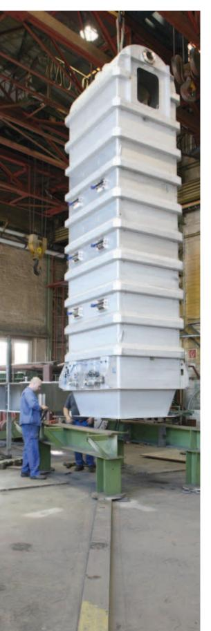
Bei der Rekonstruktion der Raffinerie in Port Wentworth, Savannah im US-Bundesstaat Georgia wurde bereits im Juli 2009 der von BMA gelieferte Trommeltrockner / -kühler in Betrieb genommen. Mit einem Durchmesser von 4 m und einer Länge von 13 m gehört er sicherlich zu den größten Trommeltrocknern für Kristallzucker, die in den USA im Einsatz sind. Er ist ausgelegt für eine Durchsatzleistung von 135 t/h.
