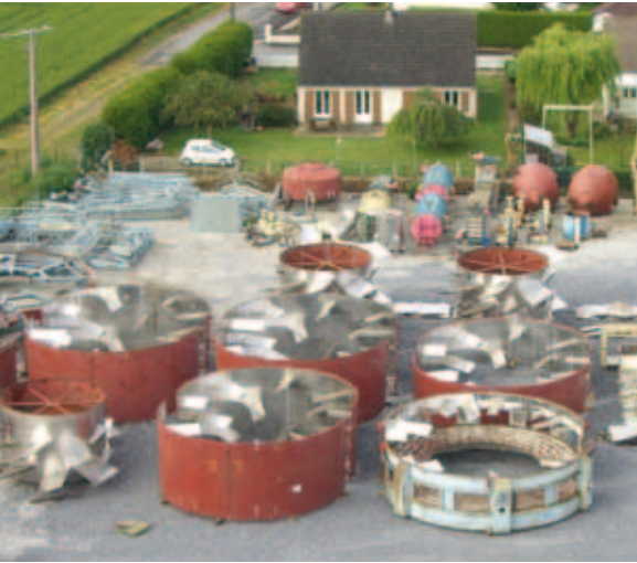
Zerlegter Extraktionsturm vor Wiederaufbau
