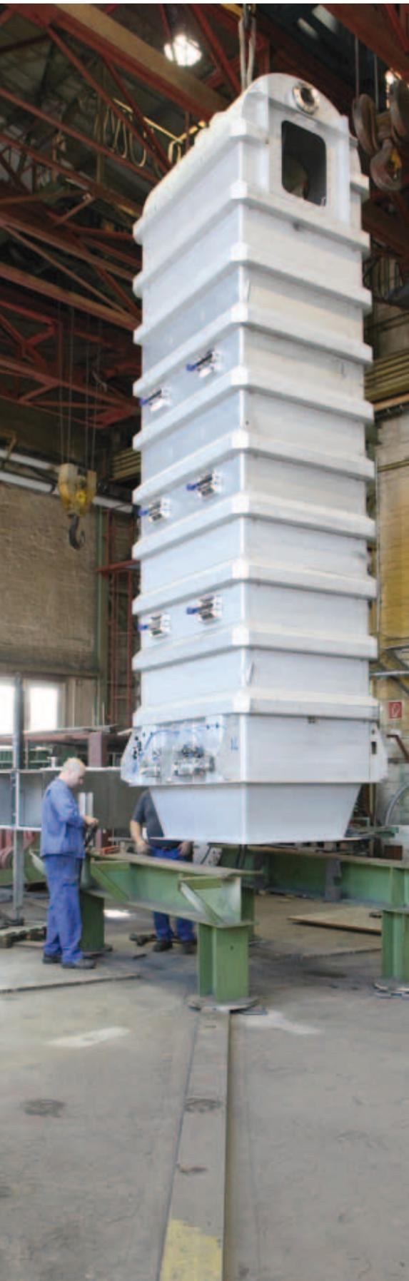
Dans le cadre de la reconstruction de la raffinerie de Port Wentworth à Savannah (Géorgie, USA), le sècheur refroidisseur à tambour fourni par BMA a déjà été mis en service en juillet 2009. Avec un diamètre de 4 m et une longueur de 13 m, il fait certainement partie des plus grands sècheurs à tambour pour sucre cristallisé actuellement en fonctionnement aux Etats-Unis. Il est dimensionné pour un débit de 135 t/h.
