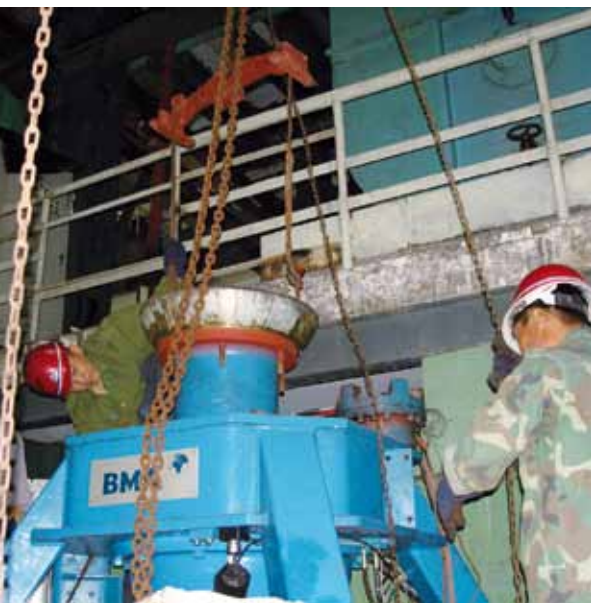
Monteure von BMA China und COFCO Tunhe bei der regulären Instandhaltung einer B-Zentrifuge
