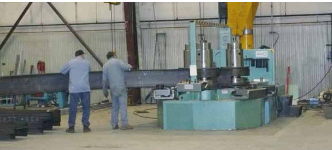
Le nouveau cylindre de cintrage
