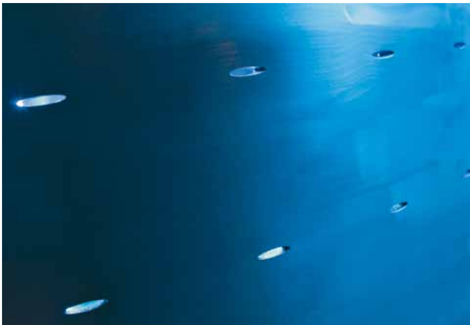
Рис. 2. Эллиптические выпускные отверстия в рубашке ротора
