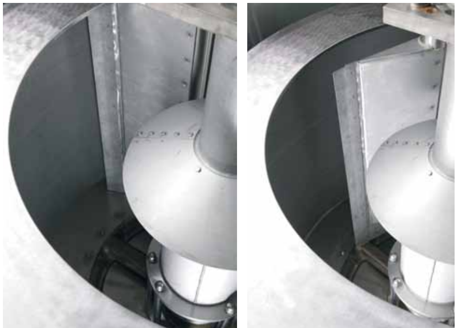
Рис. 1. Одноосный выгрузчик при остановке (слева) и при выгрузке (справа)
