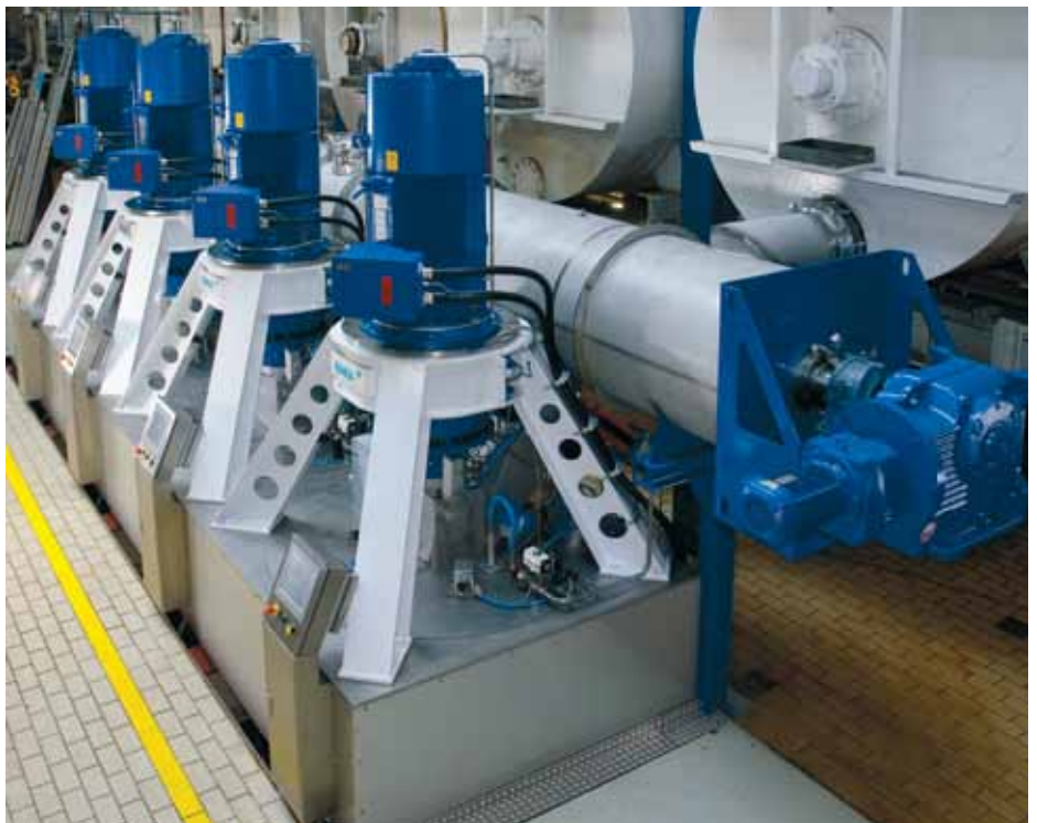
Рис. 4. Станция центрифуг (в г. Платтлинг) с 4-мя центрифугами E1810 и утфелера-спредителем БМА
